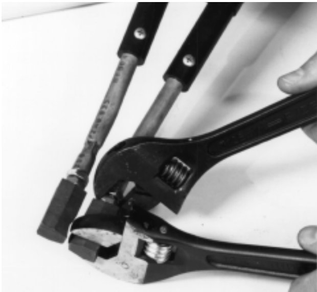
Figura 8 – Extracción de una punta de carbono
